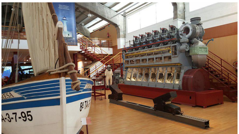
In het havenmuseum staat een heuse opengewerkte Smith & Bolnes 1.120 pk tweetakt dieselmotor met een laag toerental en 7 zuigers in lijn. De motor werd uit het koopvaardijship Dragonera gehaald, dat in 1960 door de scheepswerf Juliana Constructora Gijonesa SA werd gebouwd.
