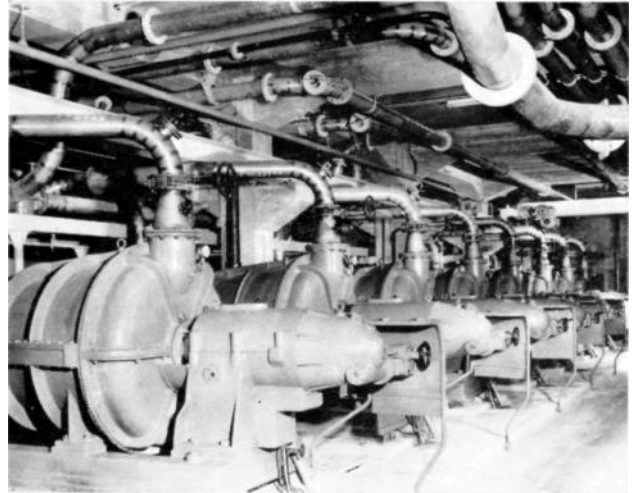
3 Batterij kegelmolens in de malerij
