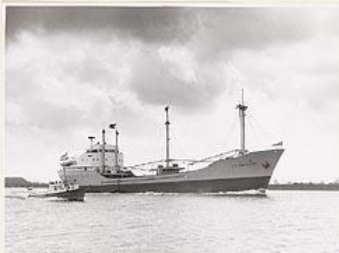
Motorschip Lis Frellsen. Opdrachtgever Ole Frellsen Roskilde te Denemarken. Het schip is lang 79,08 en breed 11,80 en heeft bouwnummer 495. De tewaterlating van de Lis Frellsen was op 2 maart 1962. GAZ Fotonummer: 25_131_07781
