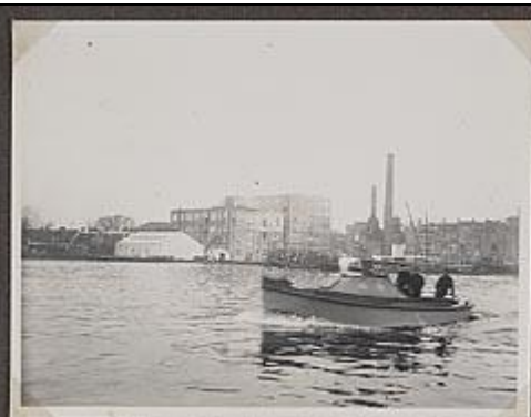
Twee motorbarkassen 9.60x2.85x1.40 meter, motor 40 PK 2-K2, bestemd voor Palestina in januari 1937. GAZ Fotonummer: 25_102_06186
