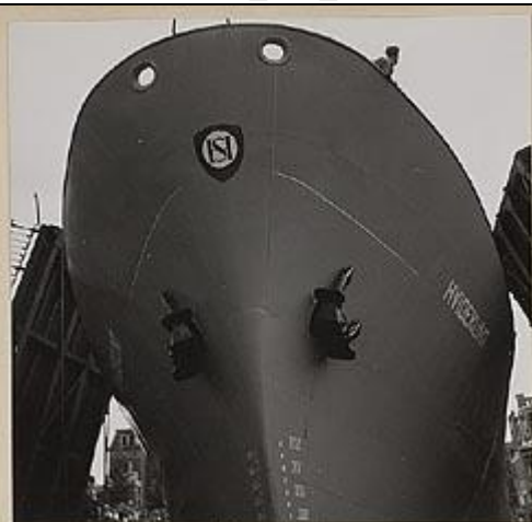
Motorcoaster Hvideklint met 500 brutoregisterton, 700 ton d.w. laadvermogen en heeft bouwnummer 469. De boeg komt met moeite door de brug van de Wilheminasluis. GAZ
