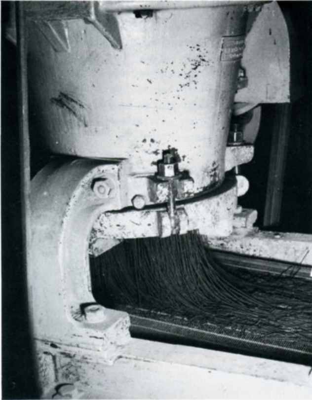
Met deze machine worden de heerlijke chocoladekorrels van Cacao De Zaan gemaakt.
